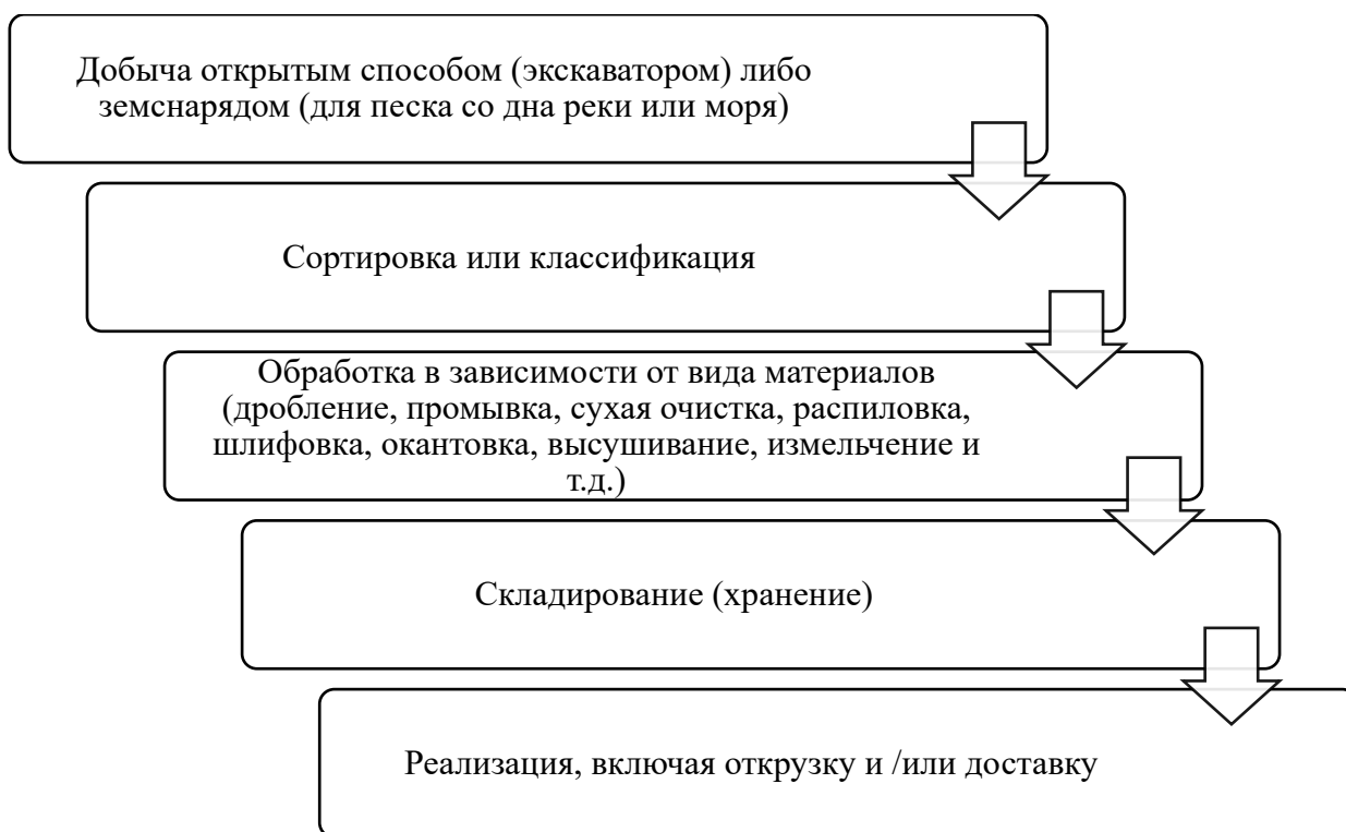
Рисунок 1 – Технология деятельности предприятия по добыче нерудных строительных материалов
